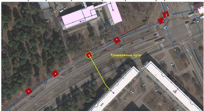
Предусмотрена реконструкция участка тепловой сети от ТК-22 на ул. Коминтерна до точки 2 в подвале жилого дома №2 микрорайона 6 с целью замены существующих трубопроводов условным диаметром DN200 на новые, а также реконструкция непроходного канала под автодорогой и трамвайными путями на полупроходной канал, расположенного по адресу: Иркутская область, г. Ангарск, ул. Коминтерна, микрорайон 6 и квартал 96.
